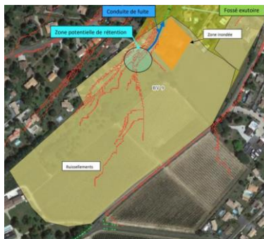
Figure 57 : Zone potentielle identifiée pour la création de bassin de rétention/infiltration (Point noir N°2)
