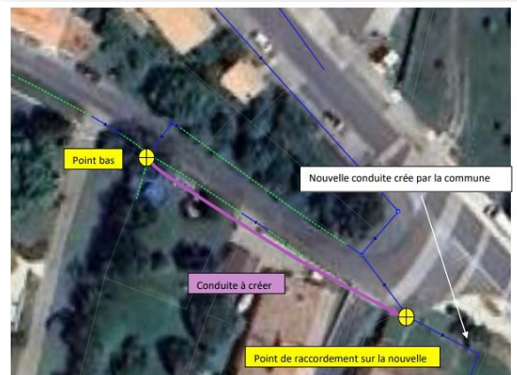
Figure 4 : 26ème variante, restauration du fossé exutoire - Chemin de Farizeau-
