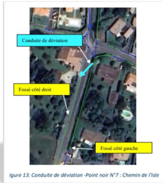
Figure 13: Conduite de déviation - Point noir N°7 - Chemin de l'Isle
