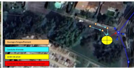
Figure 30 : Schéma illustratif d'un jardin de pluie type
